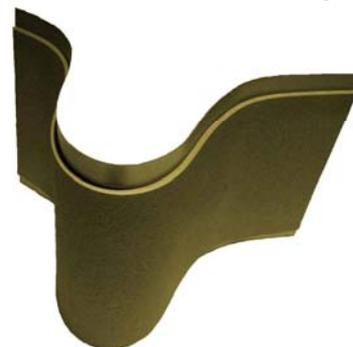
1-mm-Blech entfettet und angeschliffen + 2-mm ok-Steinl-Pulverlackspachtel
