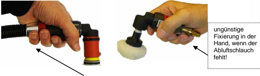
2. Die Mini-Maschine liegt besser **mit** dem Abluftschlauch in der Hand. D.h., die Maschinenführung und das Schleifergebnis sind dadurch besser.
